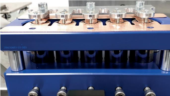
Ein aus zylindrischen Zellen und Busbar bestehender Batterieblock zur Untersuchung der Spanntechnik und Prozessparameter im Laserschweißen
