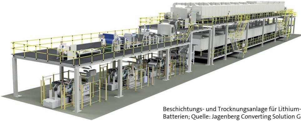
Beschichtungs- und Trocknungsanlage für Lithium-Ionen Batterien; Quelle: Jagenberg Converting Solution GmbH
