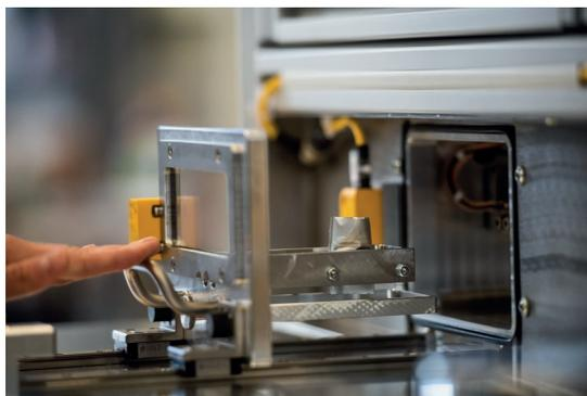
Electrolyte Jet: Semiautomatische Elektrolyt-Befüllmaschine für Pouchzellen mit Vakuumkammer
