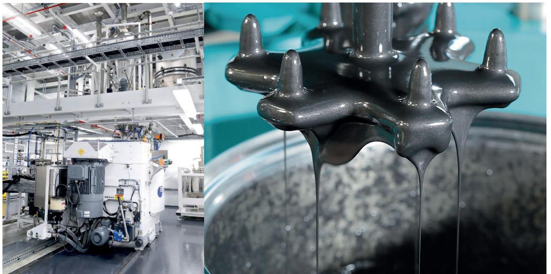
Vollautomatische 2 GWh Mischanlage für Beschichtungsmassen mit Eirich MixSolver® (links unten) und AZODOS® Dosieranlage (links oben) im UK Battery Industrialisation Centre (UKBIC)
