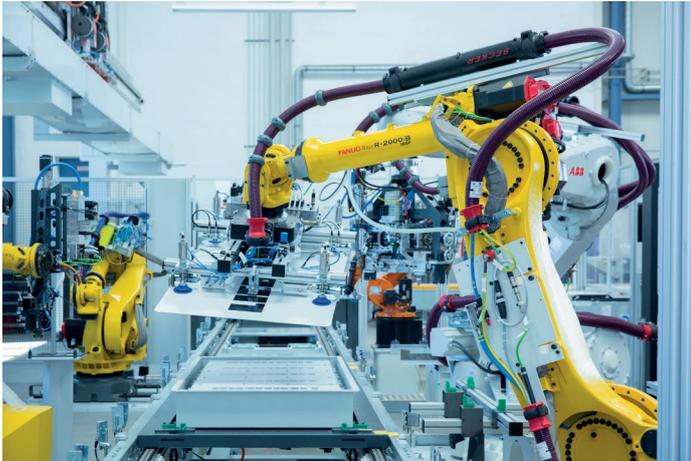
5 Module werden zum Pack montiert. Bild zeigt Aufsetzen des Gehäuseoberteils/Deckel und Verschraubung mit Batteriepackgehäuse.
