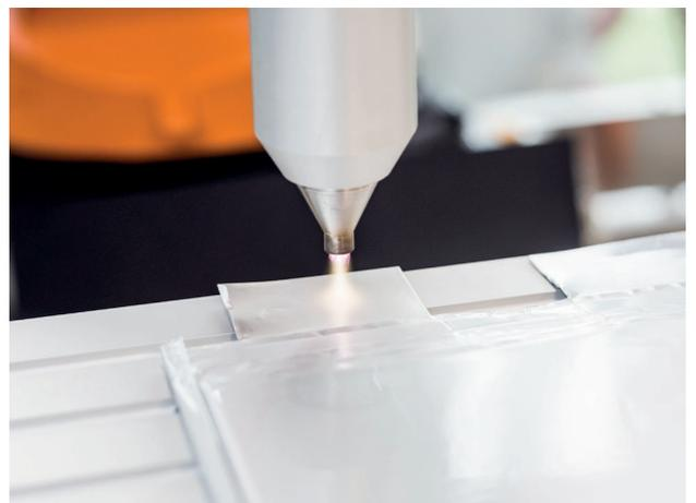
Plasmareinigung der Kontaktstelle einer Pouchzelle
