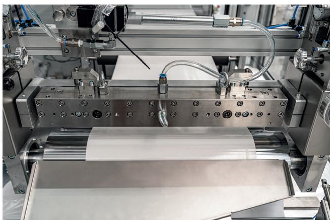
Breitschlitz-Beschichtungsanlage für Batterietechnologien,
